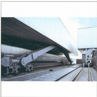
Vérins hydrauliques montés sur rails des toits des courts 1 et 2
